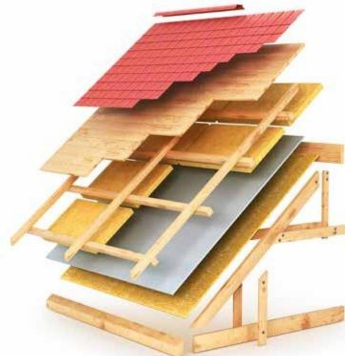
Lana de roca es un material aislante térmico compuesto en un 98% por fibras naturales. Se forma al fundir piedras minerales e inorgánicas, obtenidas de rocas volcánicas en la naturaleza, a temperaturas entre 1500-1600 grados, convirtiéndose así en fibras.
